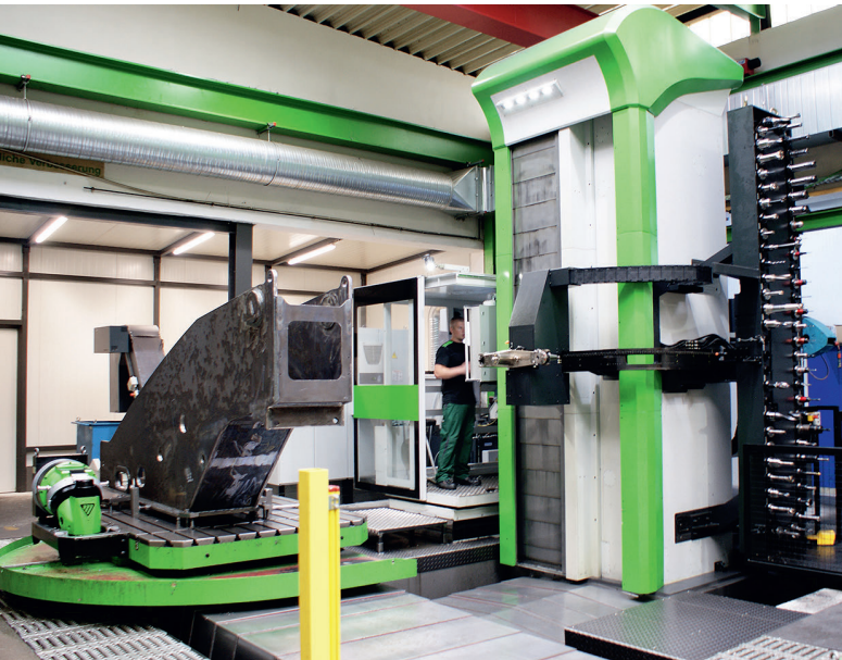
2 Das Bohr- und Fräswerk WFT 13 R CNC bei Sennebogen ist mit Kettenmagazin für 60 Werkzeuge und einem CNC-Drehtisch ausgestattet
